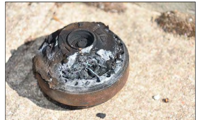
Moteur, origine de l'incendie.
