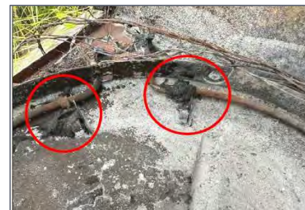
Amas de résidus accumulés sur les supports de résistance.
