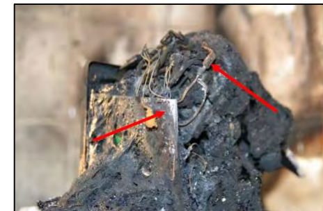
Machine à café – zone de surchauffe au niveau de la carte électronique et indice d'oxydation.
