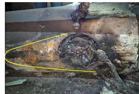
Incendie d'un ballon d'eau chaude électrique suite à une erreur de raccordement par l'installateur.
