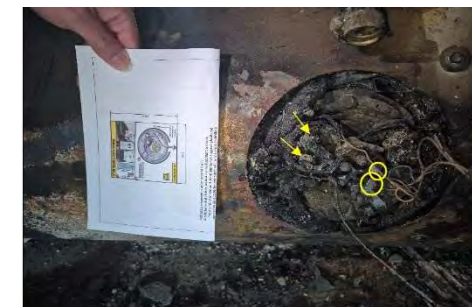
Incendie d'un ballon d'eau chaude électrique suite à une erreur de raccordement par l'installateur.
