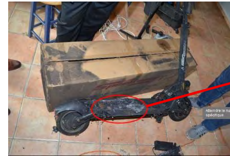
Trottinette, dommages visibles au niveau du capot (plancher).
