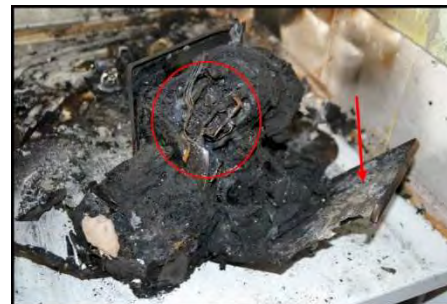
Machine à café – vue côté gauche (zone de destruction).
