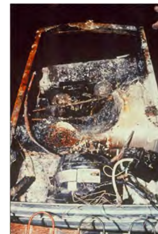
Incendie d'un réfrigérateur plaqué contre une cloison.
