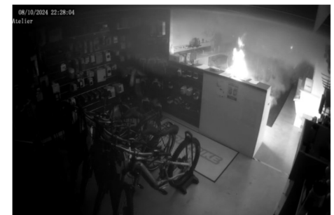
Incendie d'un vélo électrique non branché dans l'atelier d'un réparateur.
