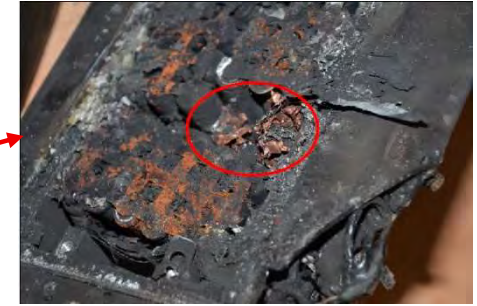
Une ou plusieurs cellules sont éclatées.
